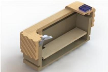
圖 3. 穿脫鞋輔助裝置立體圖(剖面)
