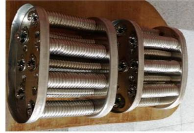
圖 22. 「改良之排氣管」之模型的內部擾流螺管
